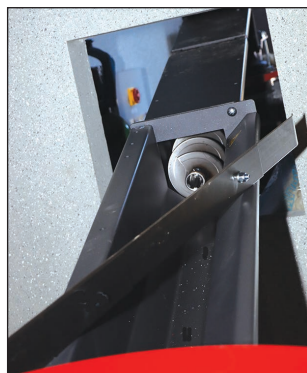
Une des deux vis qui convoie le bois déchiqueté.
